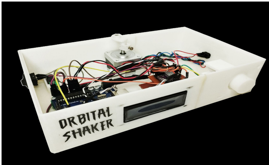
Figura 2. Sistema electrónico interno del agitador orbital
